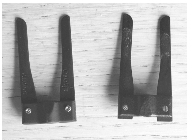
A gauche, position normale et à droite, position raccourcie. Il suffit de dévisser, retourner la lame et de revisser.
