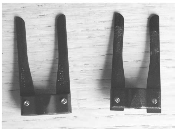
A gauche, position normale et à droite, position raccourcie. Il suffit de devisser, retourner la lame et de revisser.
